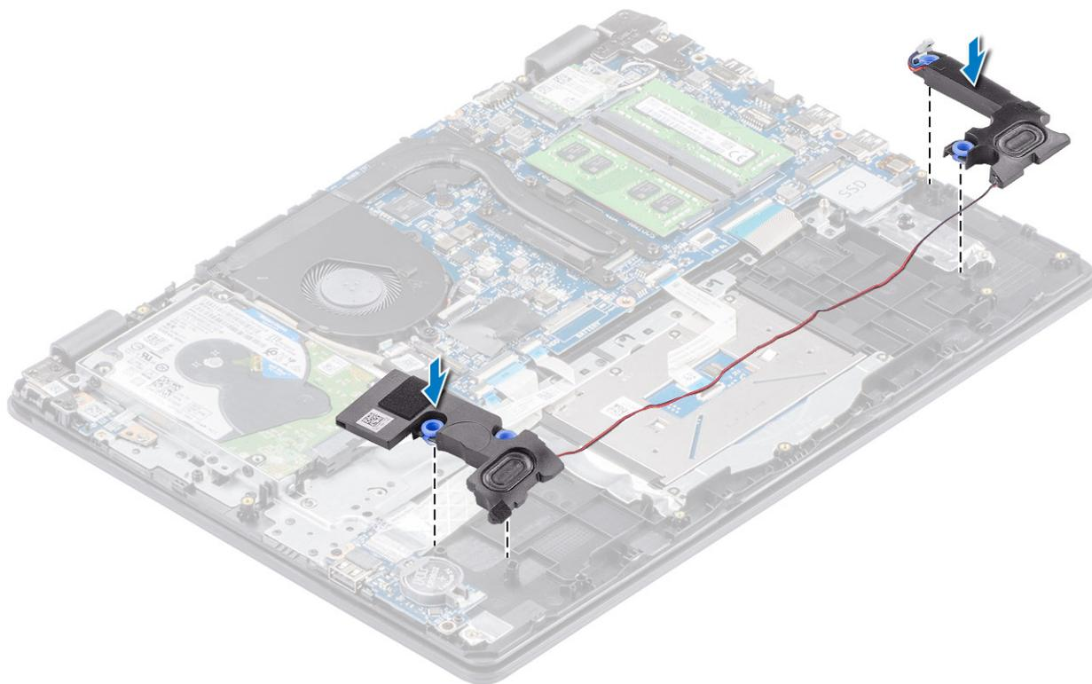
2. Coloque el cable de los altavoces en las guías de colocación del ensamblaje del teclado y del reposamanos [1].
