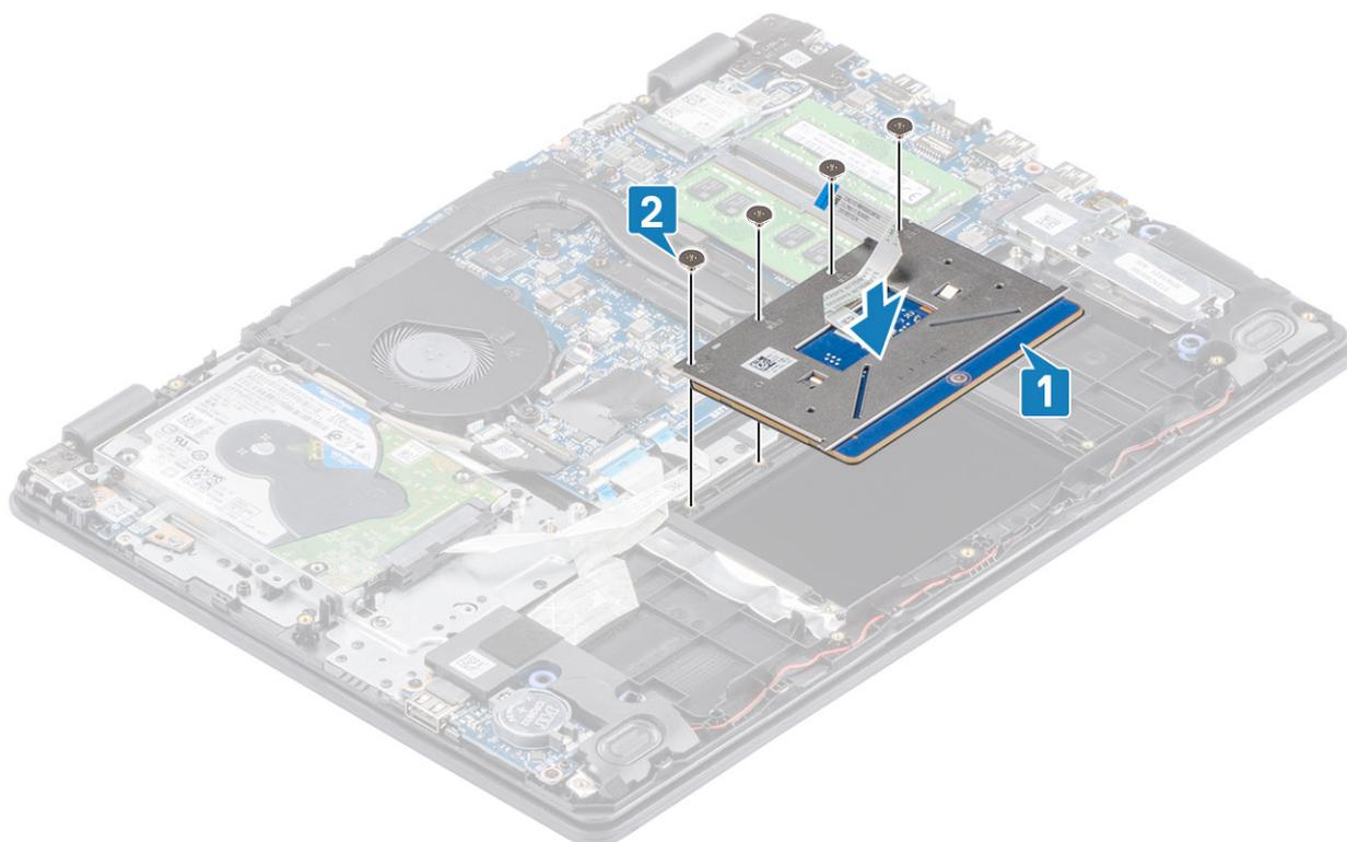
3. Adhiera la cinta adhesiva que fija la almohadilla de contacto al ensamblaje del teclado y el reposamanos [1].
