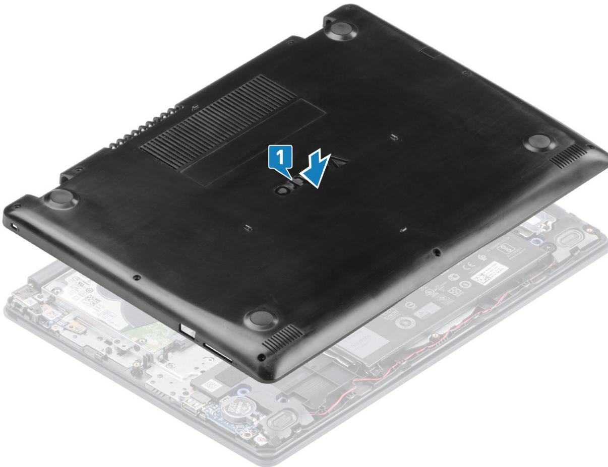
2. Presione los bordes y los laterales de la cubierta de la base hasta que encaje en su lugar.
