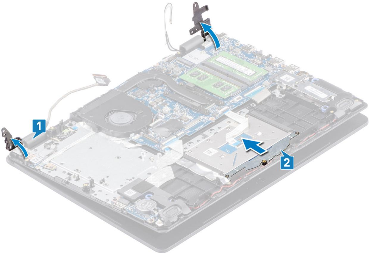
6. Deslice el ensamblaje del teclado y el reposamanos. Quite el ensamblaje del teclado y el reposamanos del ensamblaje de la pantalla
