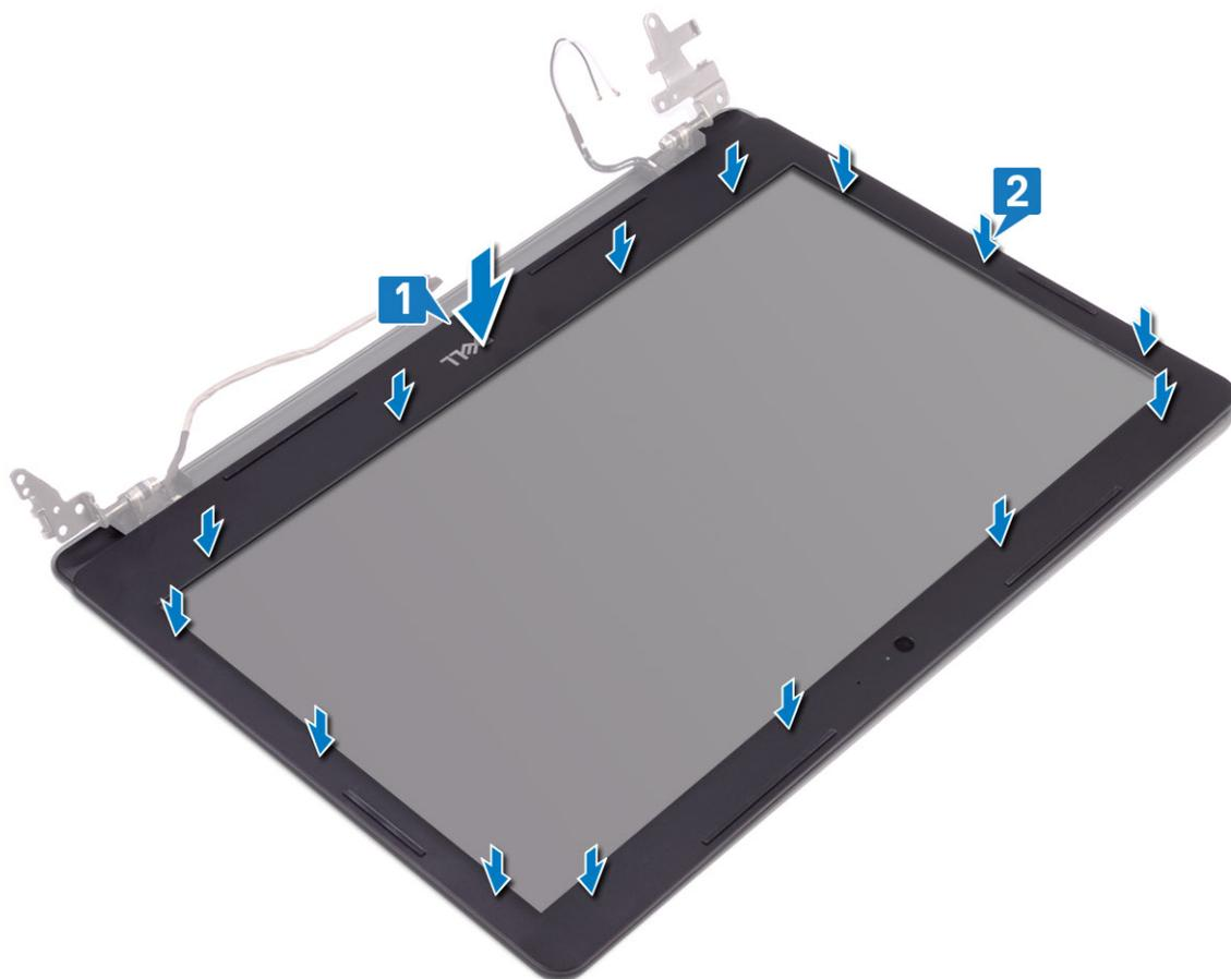
2. Inserte las lengüetas de la cubierta de la bisagra de la pantalla en las ranuras del ensamblaje de la antena y la cubierta posterior de la pantalla.
