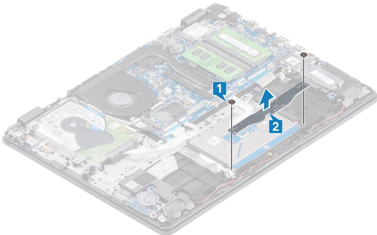
3. Despegue la cinta que fija la almohadilla de contacto al ensamblaje del teclado y el reposamanos [1].
