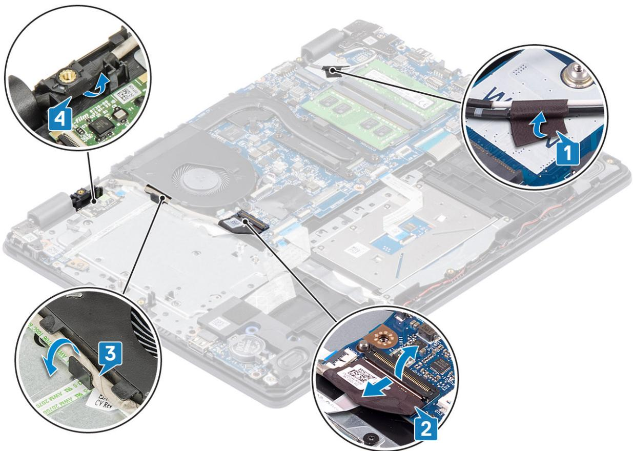
4. Quite los cuatro tornillos (M2.5x6) que fijan las bisagras izquierda y derecha a la tarjeta madre del sistema, y el ensamblaje del teclado y el reposamanos.
