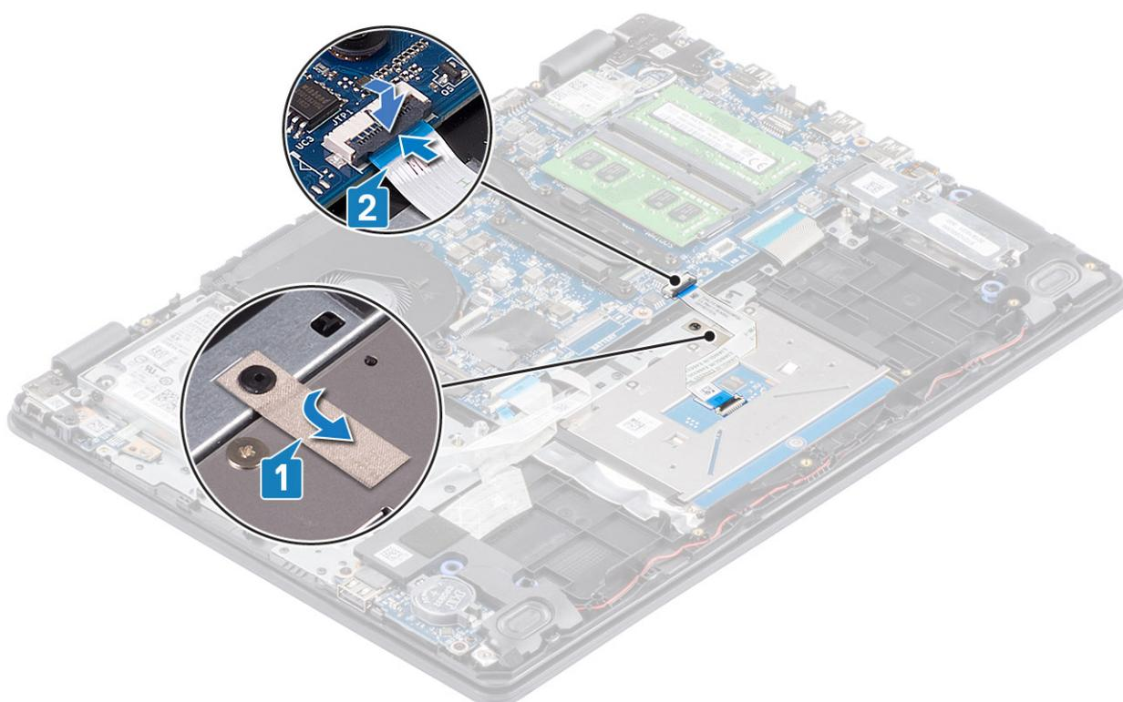
5. Coloque el soporte de la almohadilla de contacto en la ranura del ensamblaje del teclado y el reposamanos [1].
