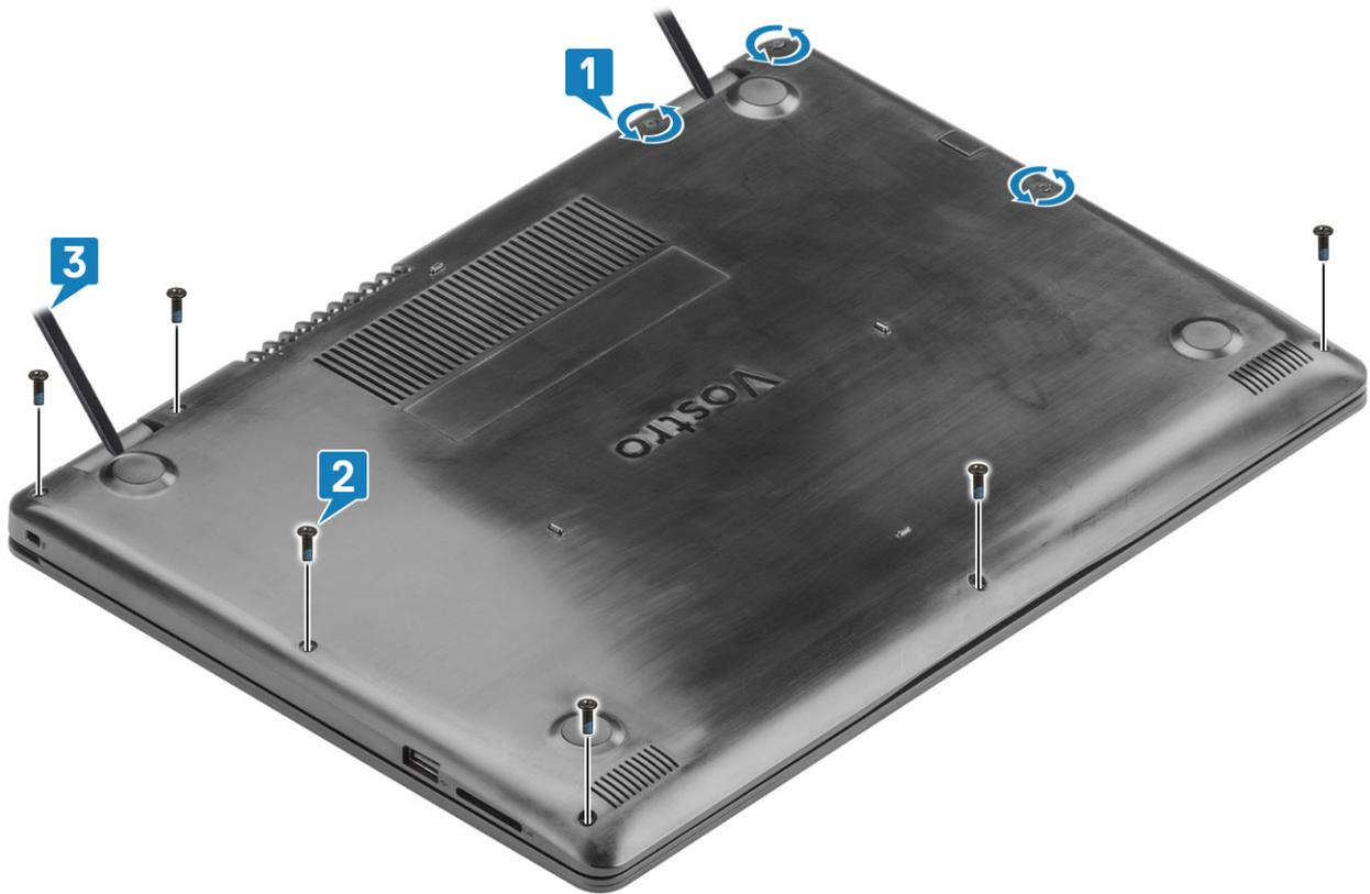
3. Con un instrumento para hacer palanca, quite la cubierta de la base del sistema [3].
