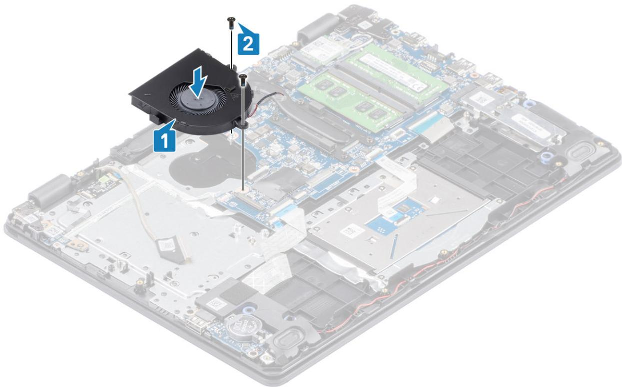
3. Pase el cable de la pantalla por las guías de colocación del ventilador [1].
