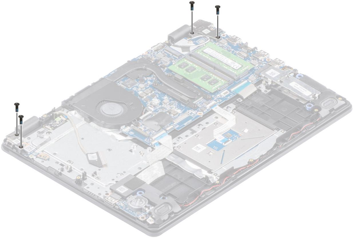
5. Levante las bisagras [1]. Levante el ensamblaje del teclado y del reposamanos en posición inclinada [2].
