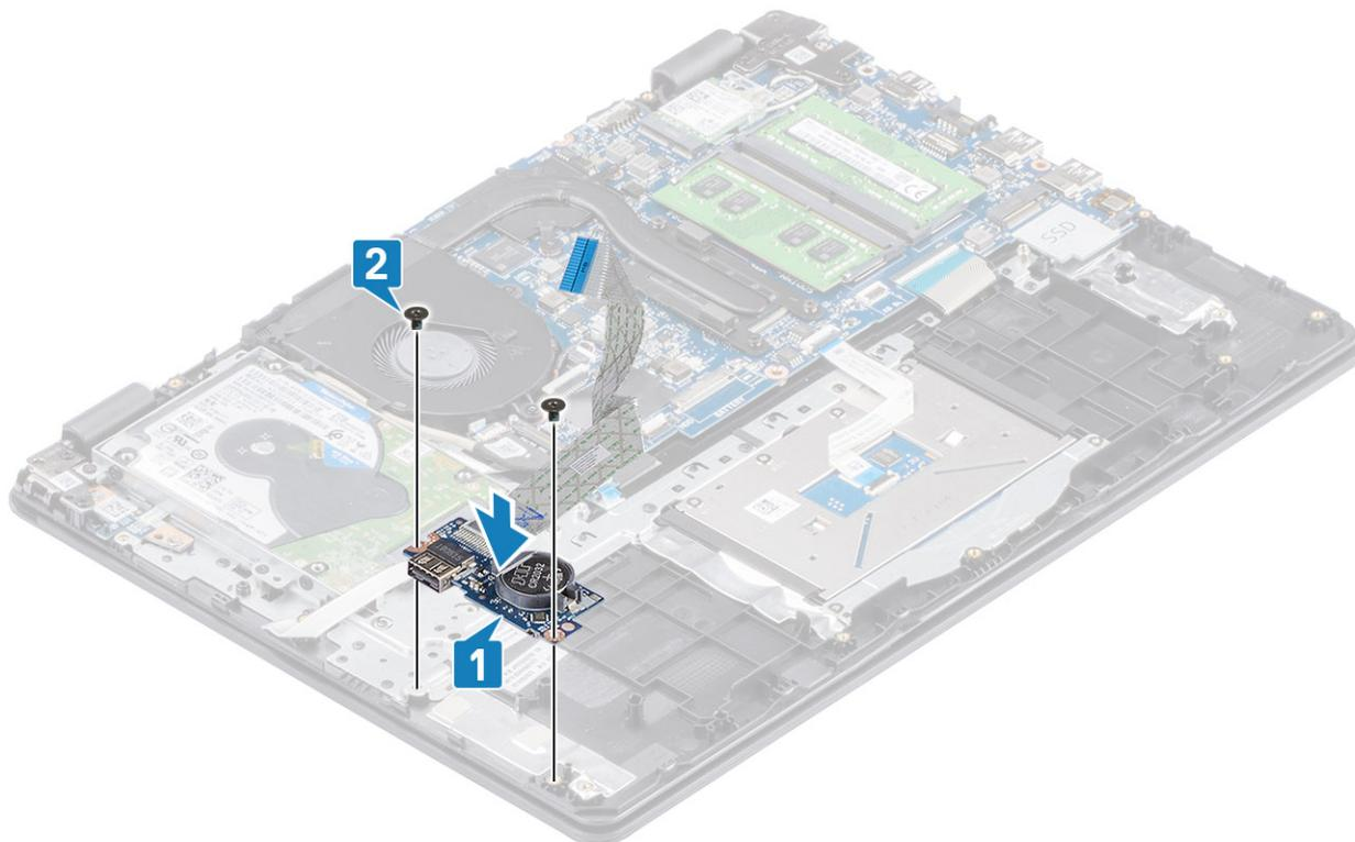
3. Adhiera el cable de la placa de E/S al ensamblaje del teclado y el reposamanos [1].
