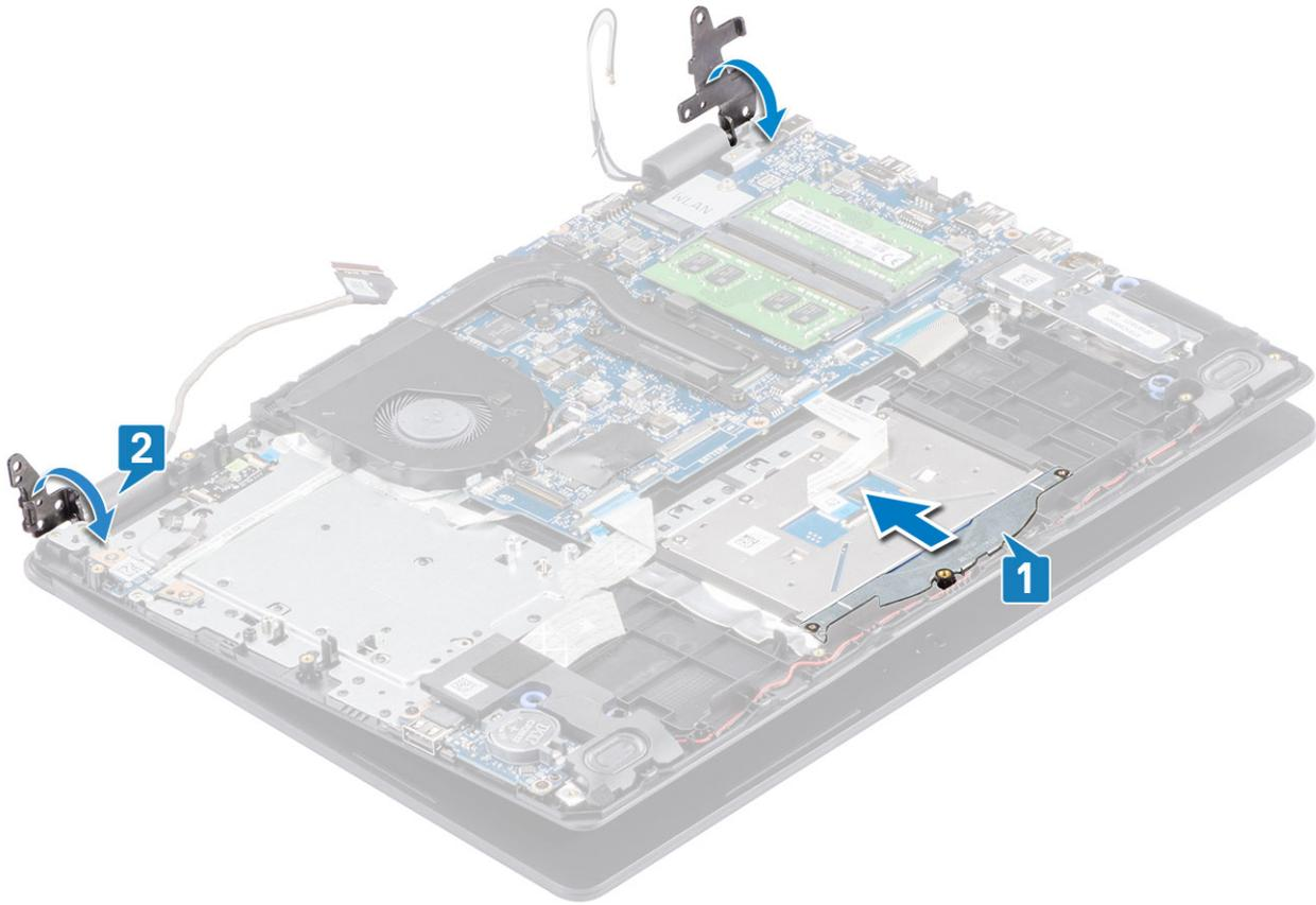
3. Reemplace los cuatro tornillos (M2.5x6) que fijan las bisagras izquierda y derecha a la tarjeta madre del sistema, y el ensamblaje del teclado y el reposamanos.
