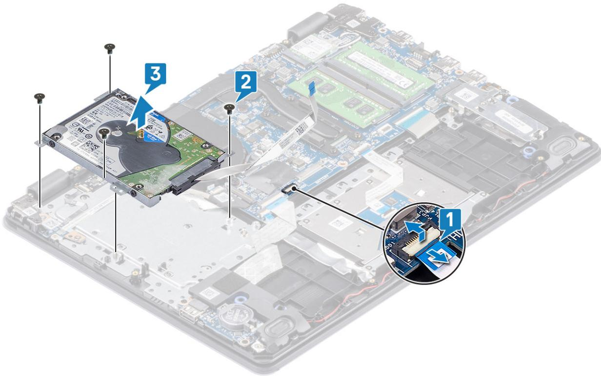
4. Desconecte la tarjeta mediadora de la unidad de disco duro.
